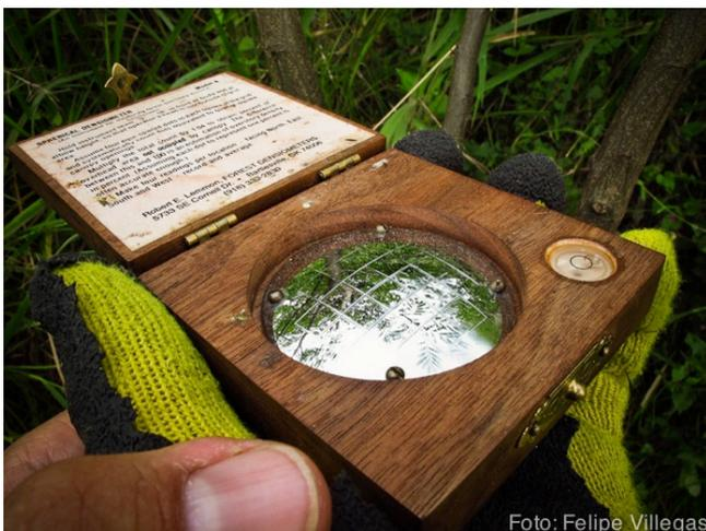
Foto 3. Densiómetro utilizado para la estimación del porcentaje de cobertura de dosel.
