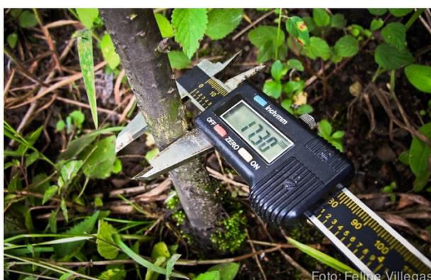
**Foto 2.** Medición del diámetro de los árboles con calibrador digital.
