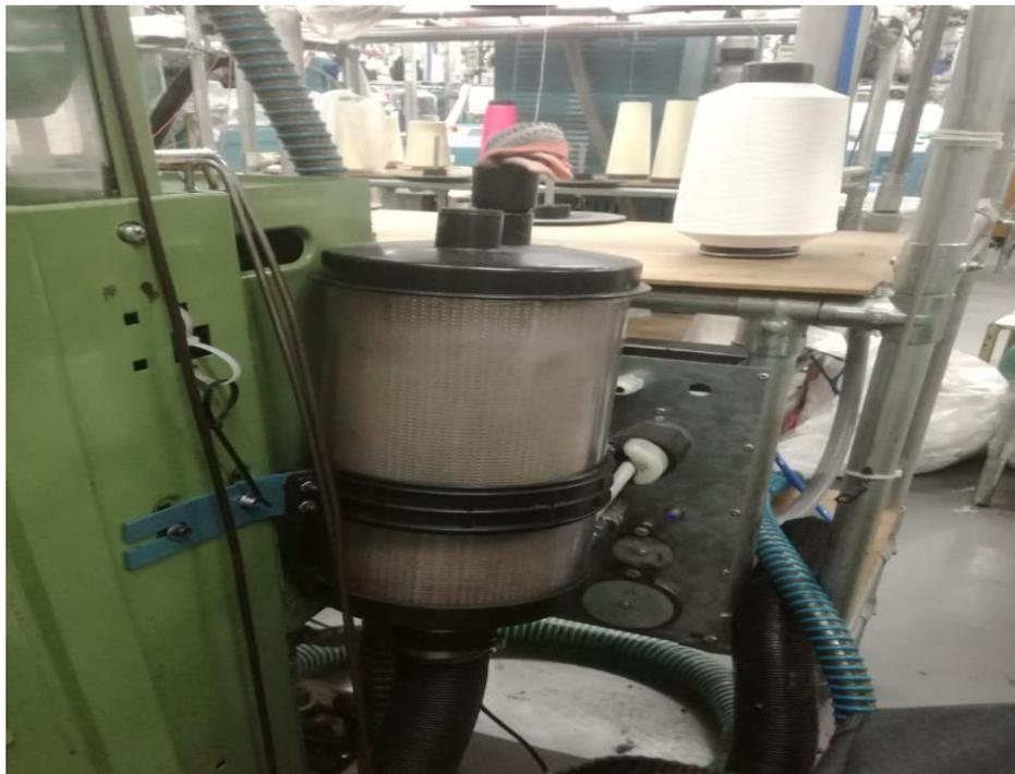
**Ilustración 18.** Implementación de filtro para recoger el desperdicio generado por la succión de la máquina. Fuente: Elaboración propia
