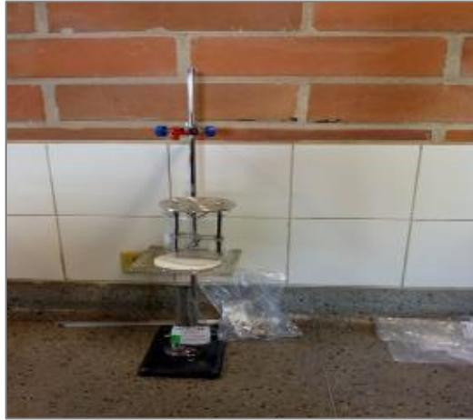
Foto 63. Penetrómetro de asfaltos
