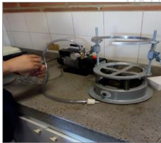
Foto 65. Picnómetro de vacío
