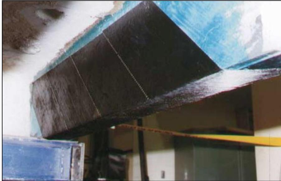
Figura 1 Reforzamiento de Viga con laminado de Materiales Compuestos (fuente: (Rodríguez J. A.-O., 2001)
