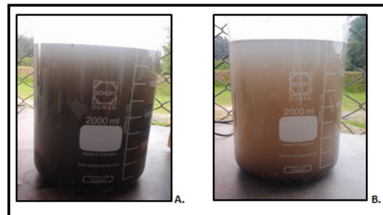
Figura 5. A. Solución de lodo homogenizado, B. Solución de lodo en reposo durante 20 horas.
