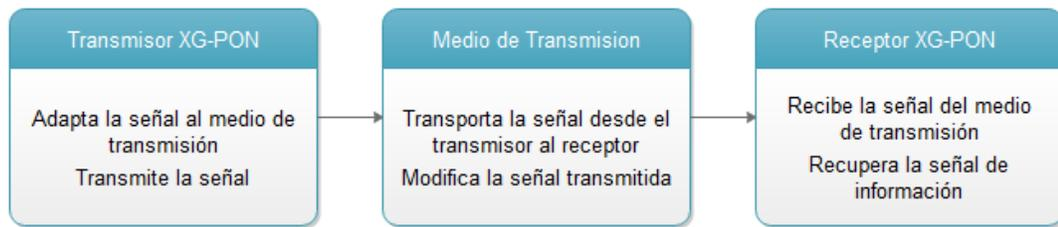
Figura 1.3. Modelo de comunicaciones punto a punto para XG-PON.
