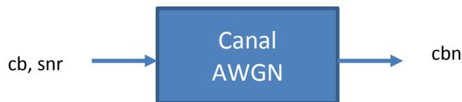
Figura F.2. Bloque Funcional Canal de Comunicaciones
