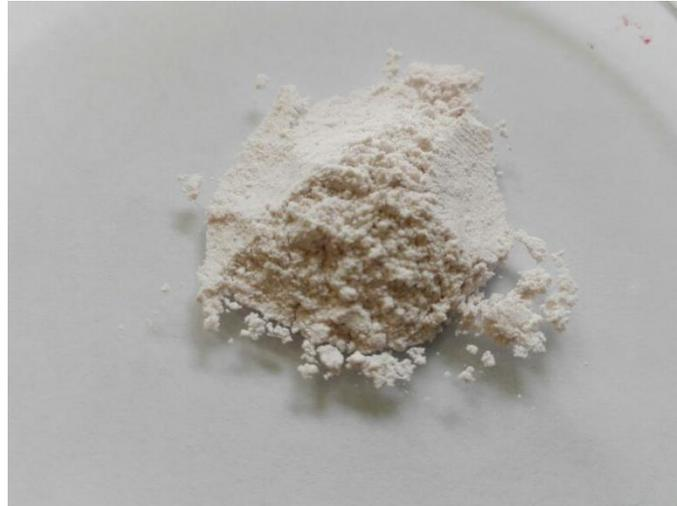
Figura 4. Polvo de sílice obtenido de la calcinación de cáscara de arroz
