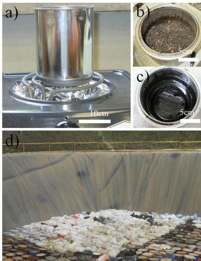
*Figura 5. a) Asfalto en contenedores como es suministrado, b) de EAFD, c) asfalto, d) Celda de seguridad El Guacal donde se depositan residuos peligrosos en Heliconia, Antioquia, Colombia.*
