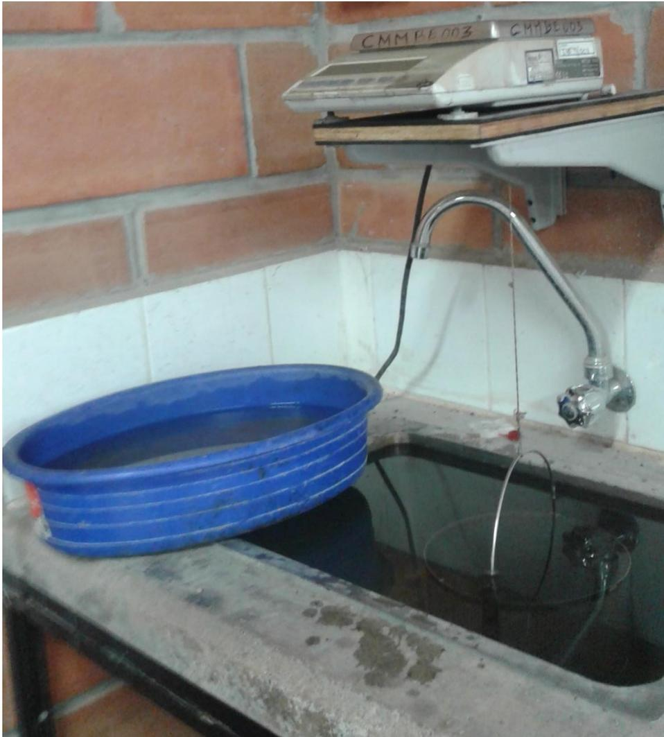
*Figura 8. Montaje para realizar medidas de altura, peso en aire, peso en agua y peso después de sumergido.*
