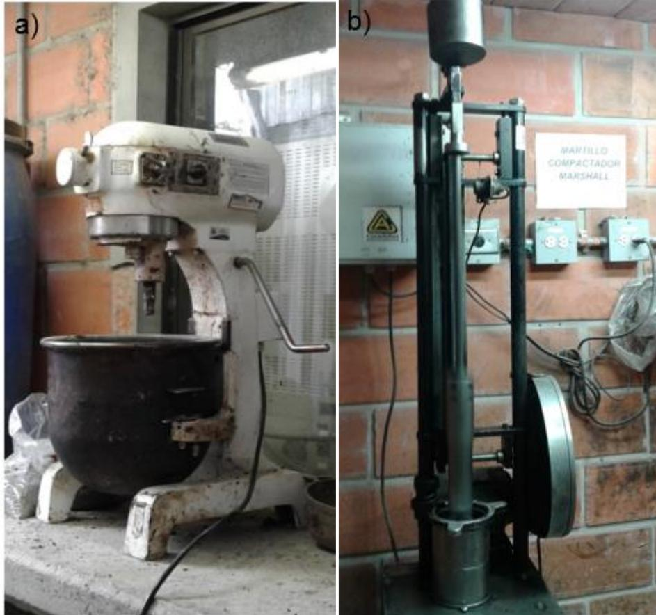
*Figura 7. Preparación de muestras de concreto asfáltico. a) Mezclador industrial, b) Martillo compactador Marshall.*
