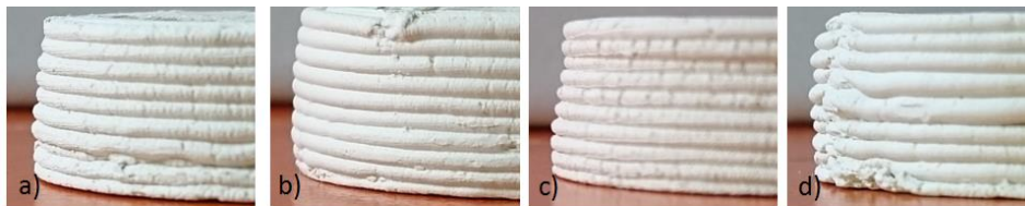
Figura 10. Detalles de las muestras impresas. 10a Vf. 50-Pol-0.2A; 10b muestra Vf. 53-Pol-0.8A; 10c muestra Vf. 50-Sil-0.2A; 10d muestra Vf. 50-Sil-0.8A.
