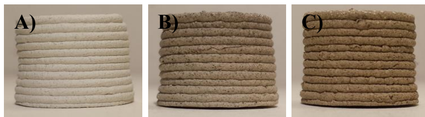
Figura 28. Detalles de las piezas impresas. A) EAF 0; B) EAF 10; C) EAF 20.
