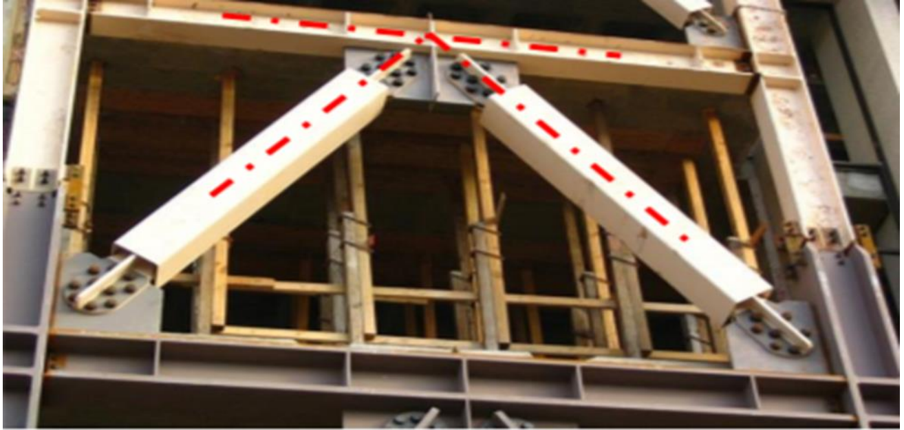
Ilustración 2. Ejemplo de un pórtico con riostras de pandeo restringido donde se observa que la conexión es concéntrica. Crisafulli, F. J. (2014).
