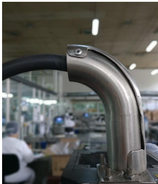
Figura 15. Mejora implementada para el daño que estaba ocurriendo en los umbilicales tanto de los CIJ como de los LÁSER.
