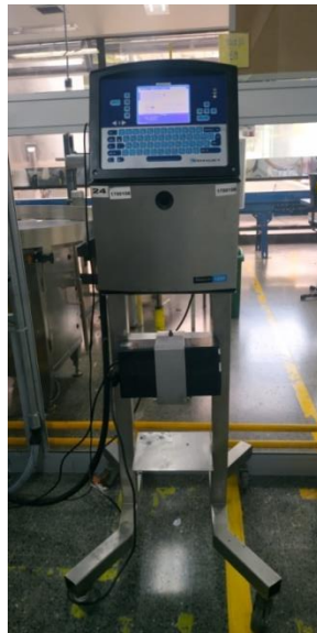
Figura 4. Equipo VIDEOJET de tecnología CIJ.
