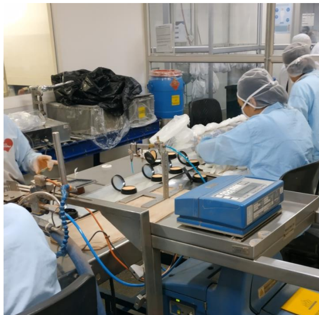
Figura 9. Línea de producción de empaqueo de polvos y bases para maquillaje. En esta figura al igual que en la anterior, el equipo codificador se sitúa en un ambiente de alta contaminación para el mismo, por lo que puede sufrir afectaciones a corto plazo.
