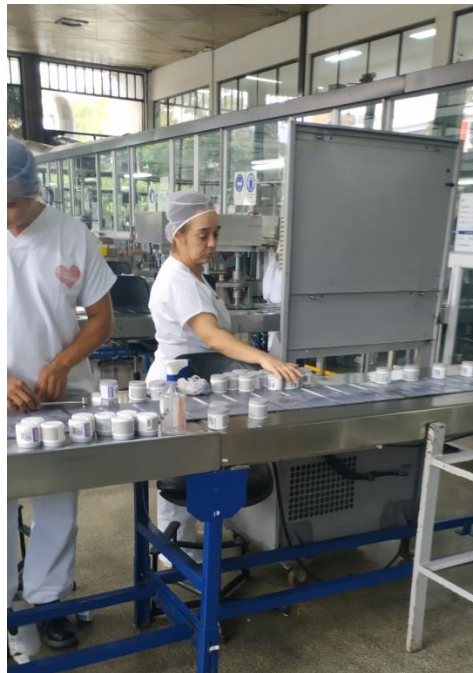
Figura 7. Línea de producción en la que se envasan cremas y/o geles. El equipo que codifica estos productos no se ve perjudicado por elementos externos de contaminación que puedan alterar su funcionamiento.
