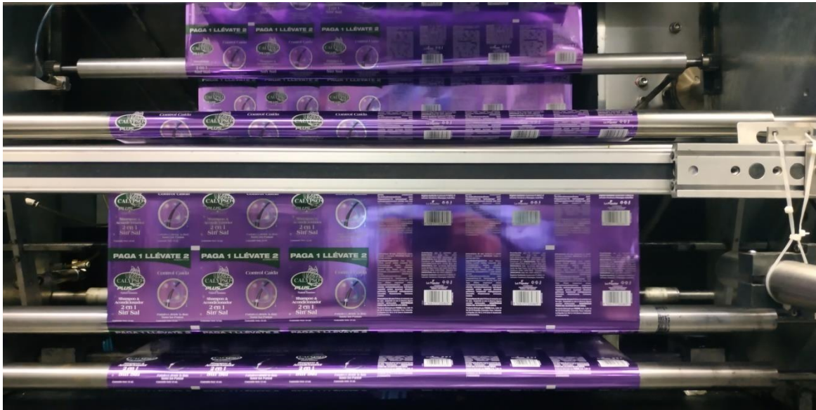
Figura 18. Máquina de empaque de Sachets. Se observa al lado derecho de la imagen el cabezal de impresión el cual se encuentra sujeto a un brazo mecánico que lo mueve para realizar la marcación sobre el producto.
