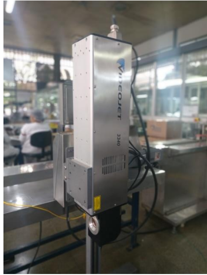
Figura 5. Equipo VIDEOJET de tecnología LÁSER.
