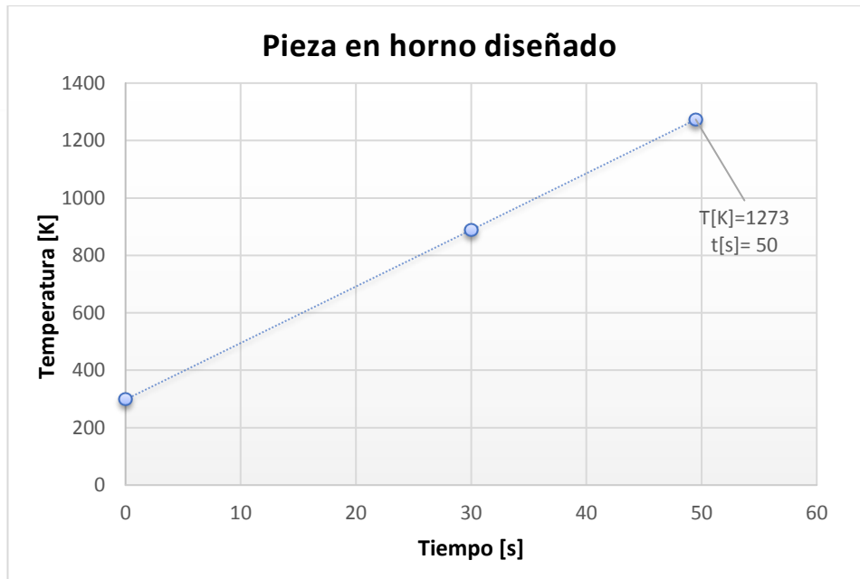
Gráfico 3. Tiempo de calentamiento de pieza en horno diseñado. Fuente: Construcción propia.
