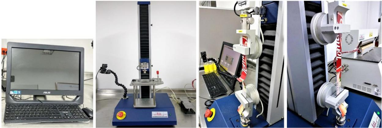
Figura 15. Máquina de ensayos universal MTT-100.
