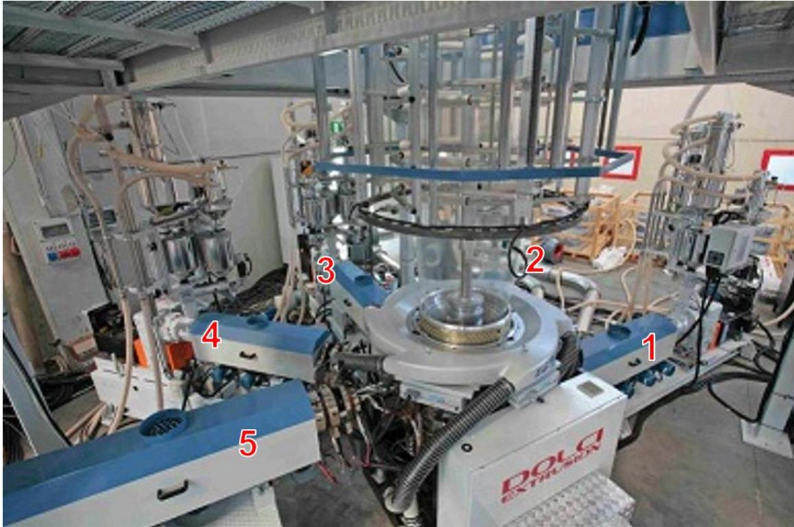
Figura 2. Proceso de coextrusión soplado de 5 capas [15].
