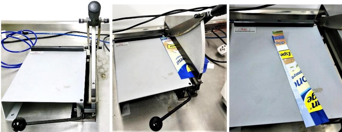
Figura 14. Guillotina para preparación de probetas Metrotec.
