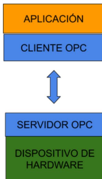
Figura 5: Estructura Servidor OPC
