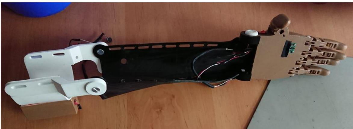
*Figura 19. Prótesis final de brazo detector de distancia.*
