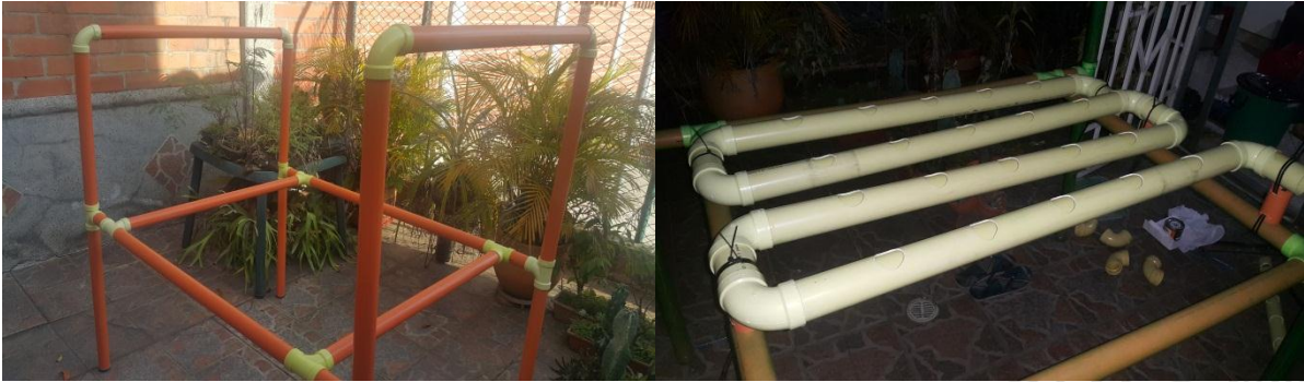
Figura 10: Estructura fabricada con tubos de PVC, en la imagen de la derecha se observan los tubos donde estarán las plantas y fluirá el agua. Fuente propia.
