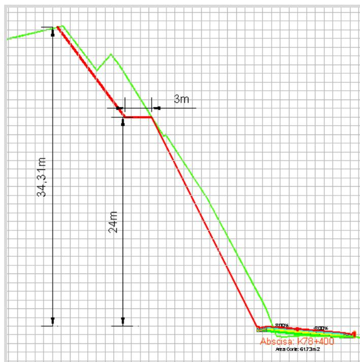
Figura 39. Sección transversal crítica de la vía en el tramo K78+392 al K78+424 (Elaboración propia).
