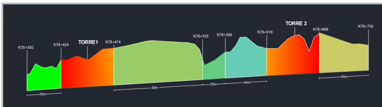
Figura 38. Vista frontal de la sectorización para el cálculo de movimiento de tierra de los cortes (Elaboración propia).
