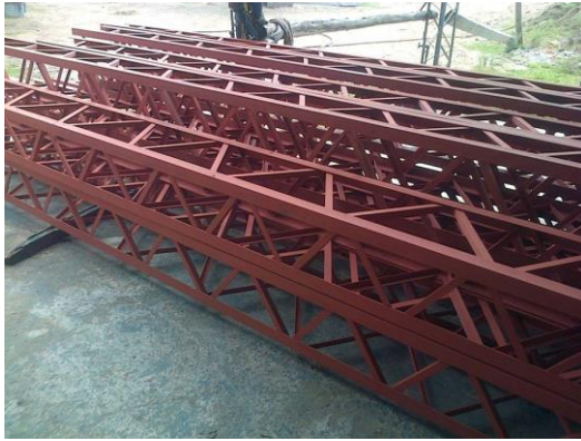
Figura 1. Cerchas de estudio, a la izquierda en forma de ángulos enfrentados y a la derecha ángulos espalda con espalda. Fuente: http://www.arquitecturaenacero.org
