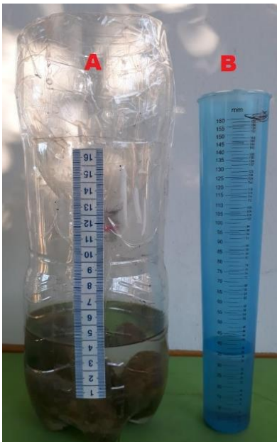
Figura 3. Pluviómetros. A. Pluviómetro casero y B. Pluviómetro Calibrado.
