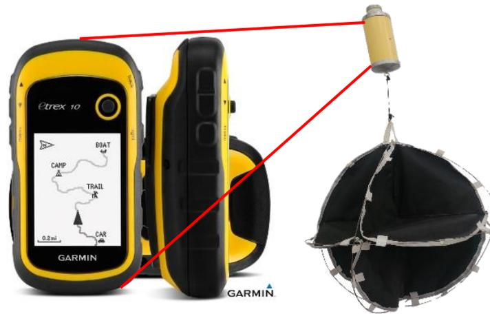
*Figura 10. GPS (Garmin eTrex 10) y derivador artesanal. Herramientas importantes en la medición de corrientes. Fuente: servicio de imágenes de Google.*
