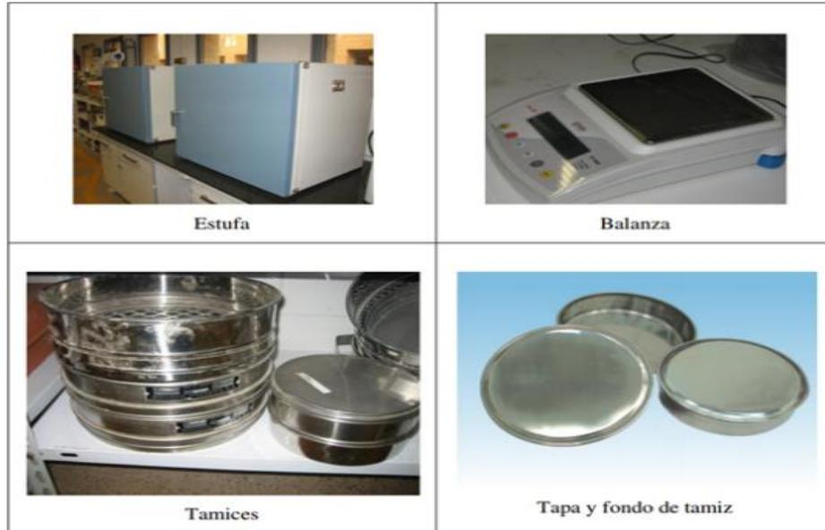
*Figura 15. Herramientas utilizadas durante la práctica de la granulometría. Fuente: “Prácticas de Materiales de Construcción” Universidad de Alicante (2008-2009).*
