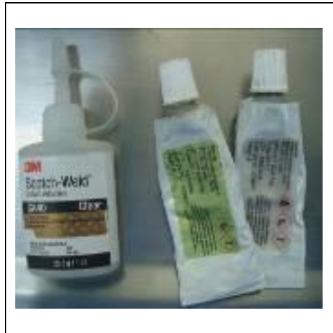
Figura 14. Adhesivos prueba Pull-off.
