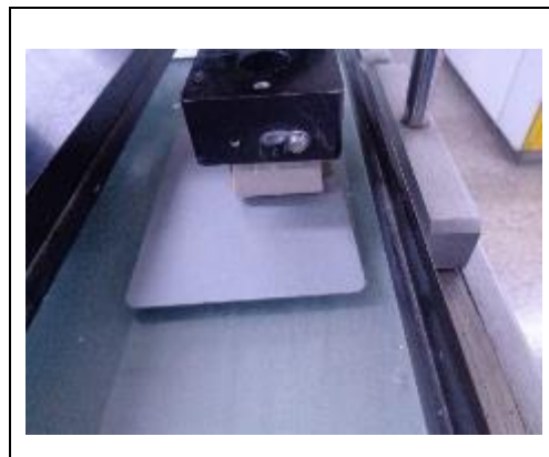
Figura 10. Prueba de lijabilidad en probador de Abrasion.
