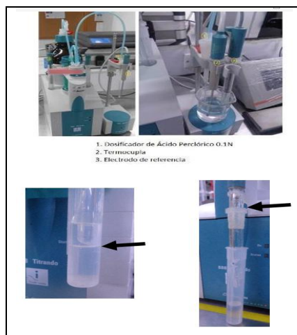
Figura 20. Limpieza y almacenamiento de electrodo.
