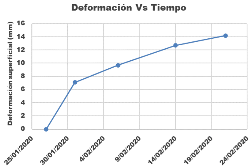
Figura 17 - Deformación superficial en el terreno.
