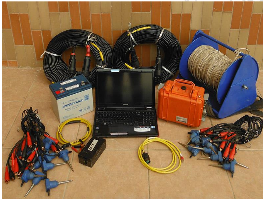
Figura 2 - Equipo usado para el ensayo de refracción sísmica (GEOSIL, 2020)
