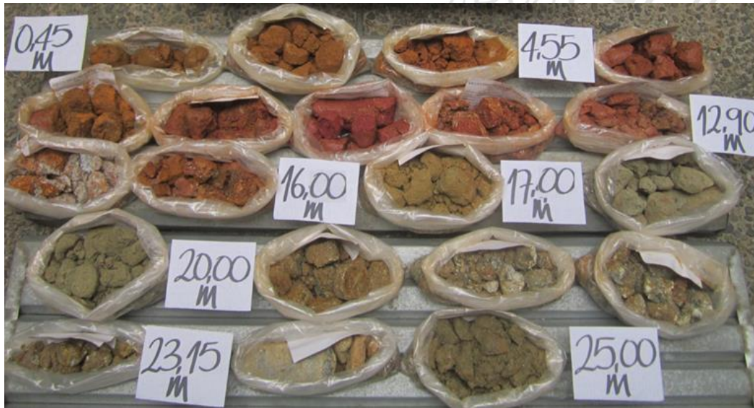
Fotografía 1 - Muestras alteradas obtenidas a partir del ensayo SPT.
