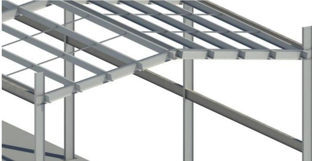
Figura 34. Detalle vigas típicas de cercha - Elaboración propia.
