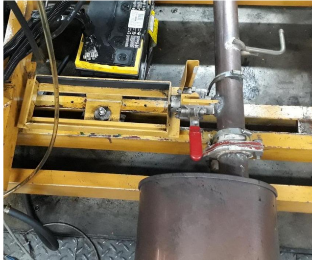
Ilustración 31. Montaje de la Válvula al Ducto de Escape
