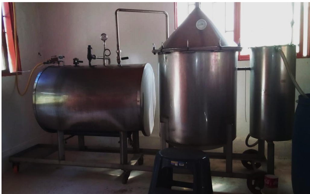
Figura 8. Extractor de esencias a escala piloto ubicado en la Secretaría de Agricultura del municipio de Girardota, Antioquia. (Fuente propia).
