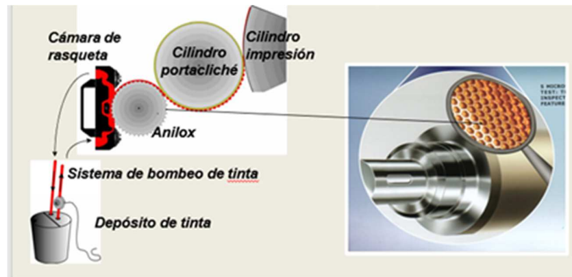
Fig 11. Sistema de rodillo anilox. [3]
