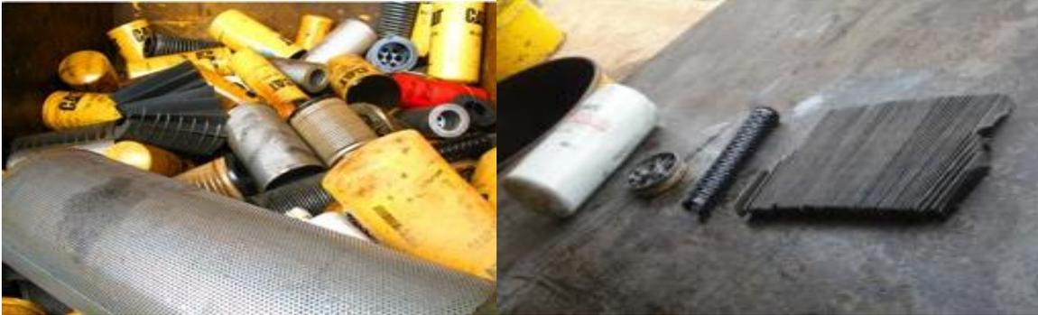
*Ilustración 17. Desmote de filtros y separación de componentes*
