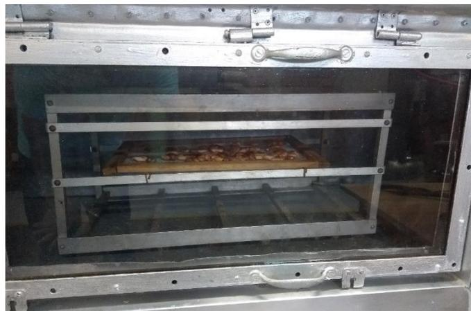
Figura 24. Secado de cacao en el laboratorio de Operaciones Unitarias UdeA.
