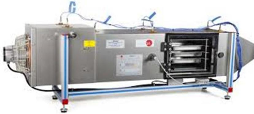
Figura 7. Secador de bandeja tipo túnel. Tomado de [23].
