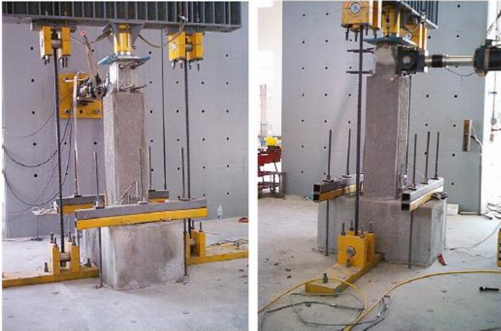
Ilustración 6. Configuración de prueba y ensayo de especímenes con encamisado en concreto.
