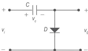
Figura 7. Circuito sujetador.
