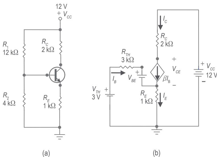
**Figura 2.** (a). Circuito del amplificador en corriente directa; (b). Circuito equivalente.
