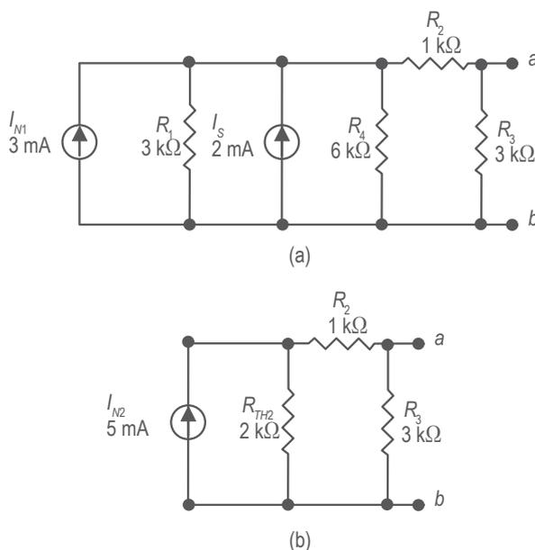
Figura 9. (a). Circuito equivalente; (b). Circuito equivalente simplificado.
