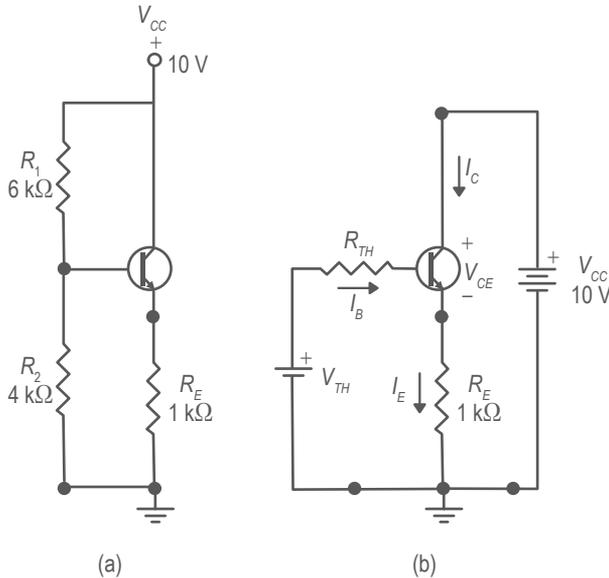
**Figura 6.** (a). Circuito del amplificador en corriente directa; (b). Circuito con el equivalente Thevenin.
