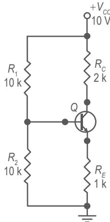
Figura 1. Circuito de polarización del transistor.
