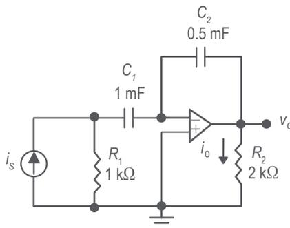
Figura 5. Circuito R-C con amplificador operacional.
