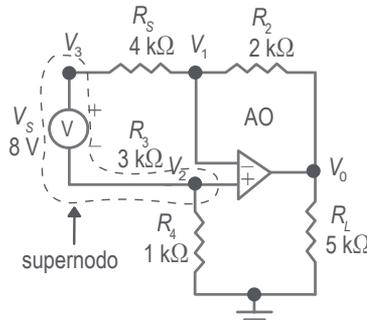
**Figura 4.** Circuito simplificado con sus voltajes de nodo:  $V_1$ ,  $V_2$ ,  $V_3$  y  $V_4$ .
