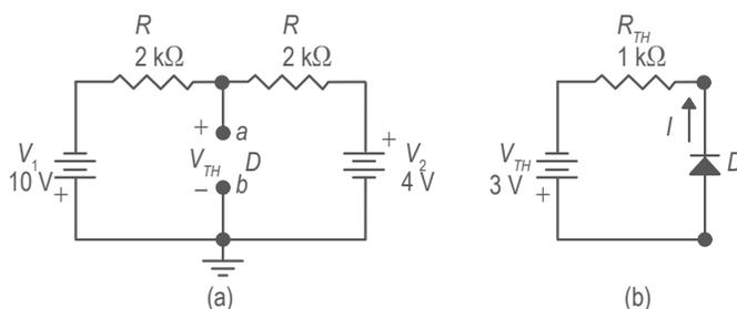
Figura 2. (a). Circuito para calcular el Thevenin en las terminales del diodo;
