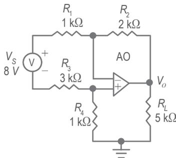
Figura 3. Circuito con un amplificador operacional
