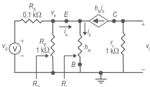
**Figura 4.** Circuito equivalente del amplificador en corriente alterna.
