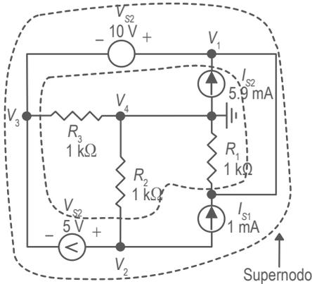
Figura 3. Circuito con el supernodo que encierra los nodos 1, 2 y 3.
