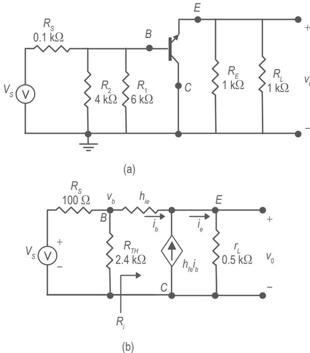
**Figura 7.** (a). Circuito del amplificador en corriente alterna; (b). Circuito equivalente.
