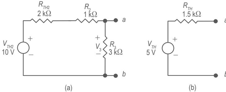
**Figura 10.** (a). Circuito equivalente con fuente de voltaje; (b). Equivalente Thevenin.
