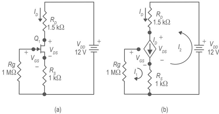
Figura 4. (a). Circuito inicial; (b). Circuito equivalente.
