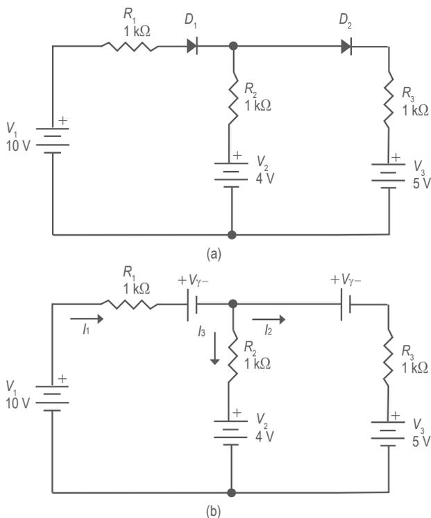
Figura 6. (a). Circuito inicial; (b). Circuito equivalente.
