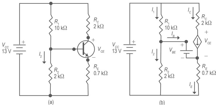
**Figura 8.** (a). Circuito original; (b). Circuito equivalente en la región activa.
