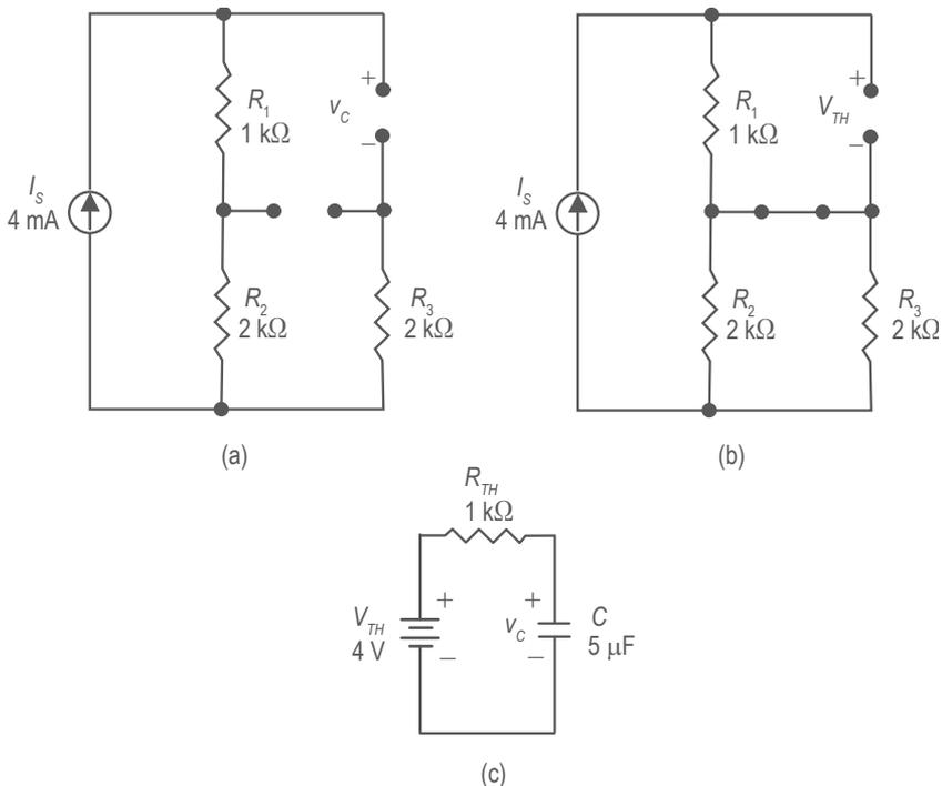
**Figura 4.** (a). Circuito equivalente para  $t < 0$ ; (b). Circuito equivalente para calcular el Thevenin, en  $t > 0$ ; (c). Circuito R-C equivalente para  $t > 0$ .
