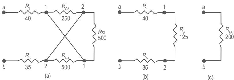
Figura 2. Circuitos equivalentes al de la figura 1.
