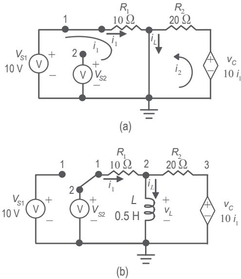
Figura 8. (a). Circuito R-L en estado estable  $t < 0$ ; (b). Circuito R-L para  $t > 0$ .
