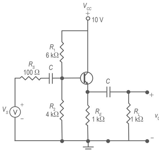
Figura 5. Amplificador en colector común.
