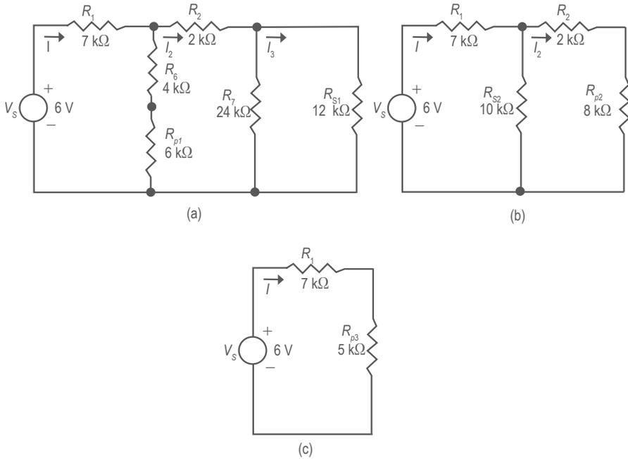
Figura 4. Circuitos equivalentes al de la figura 3.
