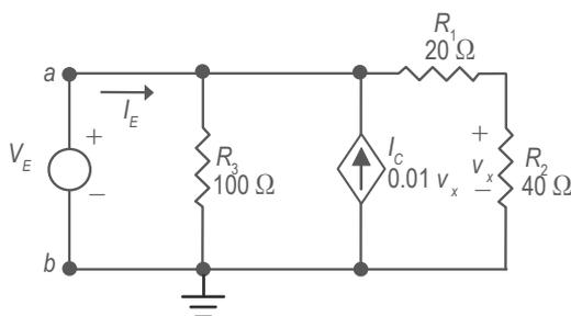
Figura 5. Circuito con la fuente externa  $V_E$ .
