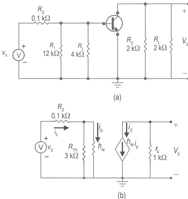
**Figura 3.** (a). Circuito del amplificador en corriente alterna; (b). Circuito equivalente.
