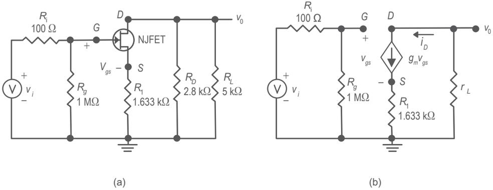
Figura 5. (a). Circuito del amplificador en corriente alterna; (b). Circuito equivalente con el modelo del JFET en corriente alterna.
