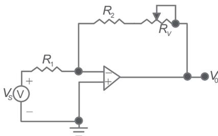
Figura 1. Amplificador inversor de ganancia variable.
