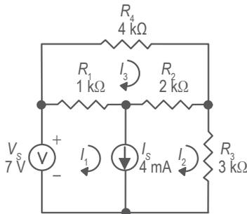
Figura 2. Circuito con tres mallas y una fuente de corriente interna.
