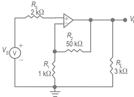
Figura 2. Circuito amplificador.
