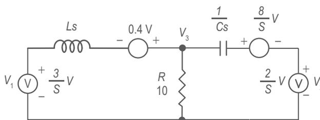
Figura 2. Circuito RLC transformado.
