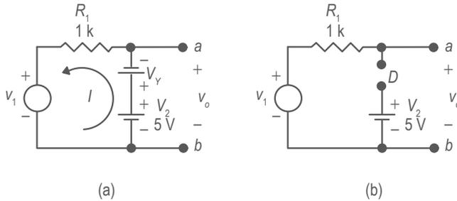
**Figura 6.** (a). Circuito equivalente en conducción; (b). Circuito equivalente en no conducción.
