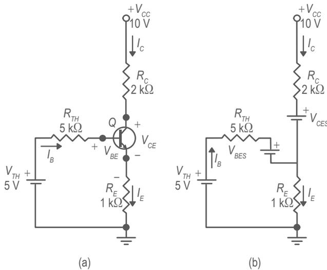
**Figura 2.** (a). Circuito con el equivalente Thevenin en la región activa; (b). Circuito equivalente del transistor en la región de saturación.
