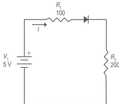
**Figura 1.** Circuito con diodos.
