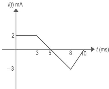
Figura 1. Forma de la corriente a través de la bobina de 0.2 H.
