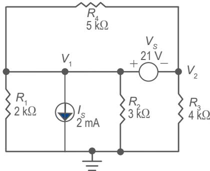
Figura 4. Circuito con cuatro nodos.
