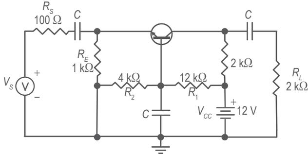
Figura 1. Amplificador en base común.
