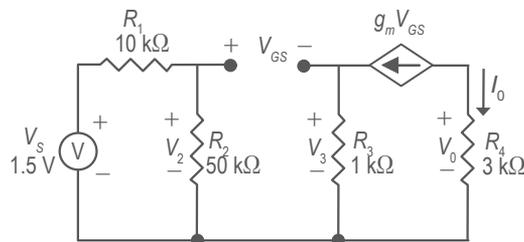
Figura 1. Circuito equivalente de un amplificador con FET.
