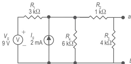
Figura 8. Circuito para determinar la máxima potencia de salida.
