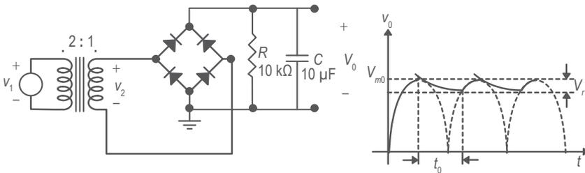
**Figura 4.** (a). Fuente con rectificador de onda completa; (b). Voltaje de salida.
