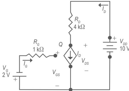
**Figura 5.** Circuito equivalente.
