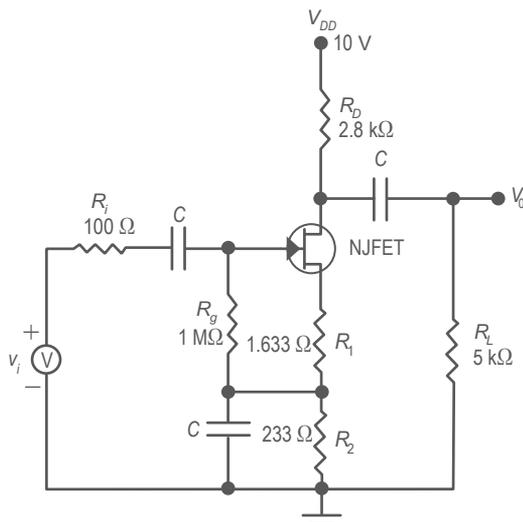
Figura 4. Circuito amplificador en fuente común con los valores de  $R_1$  y  $R_2$  calculados en el numeral 8.
