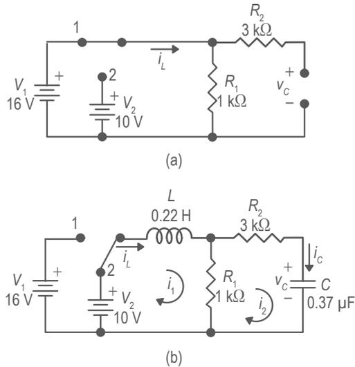
Figura 2. (a). Circuito equivalente en estado estable en  $t < 0$ ; (b). Circuito para  $t > 0$ .
