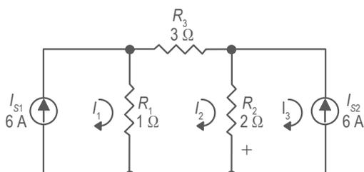
Figura 1. Circuito con tres mallas y fuentes de corriente en la periferia.
