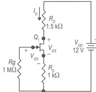
Figura 4. Circuito con transistor efecto de campo JFET.
