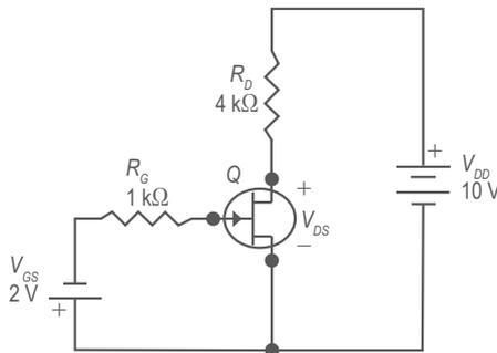
**Figura 4.** Circuito con un transistor efecto de campo JFET.
