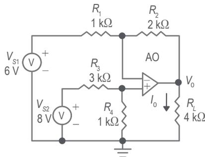
Figura 5. Circuito con amplificador operacional.
