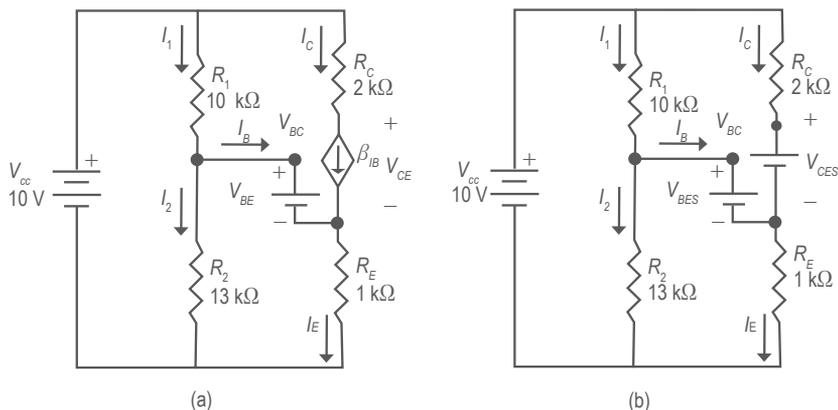
Figura 10. (a). Circuito equivalente en la región activa; (b). Circuito equivalente en saturación.
