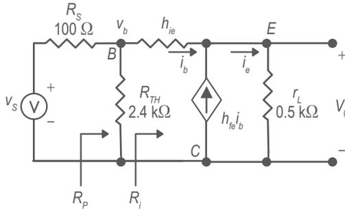
Figura 8. Circuito equivalente del amplificador en corriente alterna.
