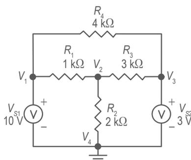
Figura 1. Circuito con cuatro nodos.
