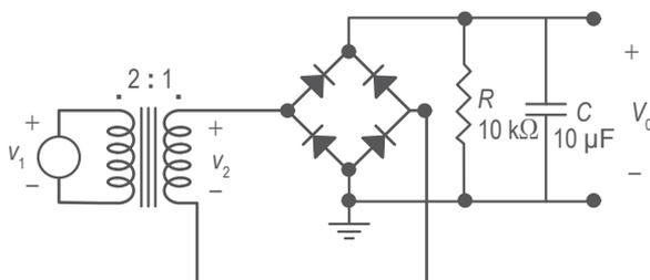
Figura 3. Fuente con rectificador de onda completa y filtro RC.
