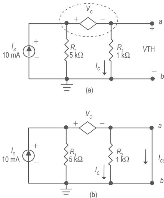
**Figura 7.** (a). Circuito inicial; (b). Circuito para calcular la corriente de cortocircuito.
