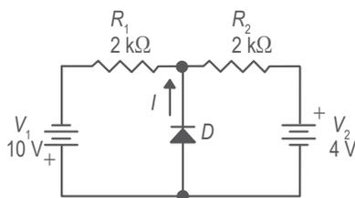
Figura 1. Circuito con un diodo ideal.
