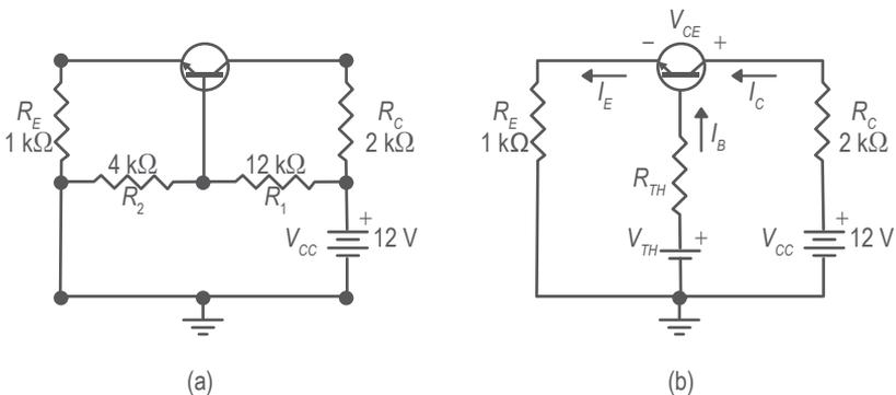
Figura 2. (a). Circuito del amplificador en corriente directa; (b). Circuito equivalente con el equivalente Thevenin.
