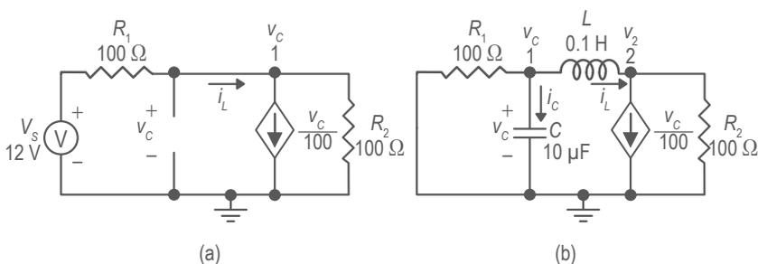
Figura 4. (a). Circuito equivalente en estado estable en  $t < 0$ ; (b). Circuito para  $t > 0$ .
