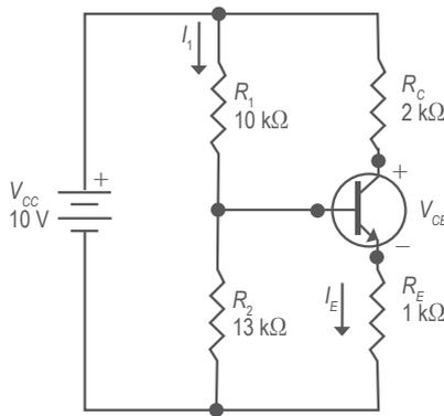
Figura 9. Circuito con transistor bipolar.
