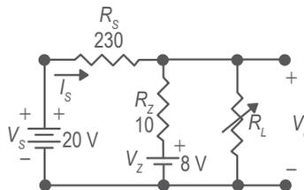
Figura 9. Circuito equivalente de la fuente regulada con diodo zener.
