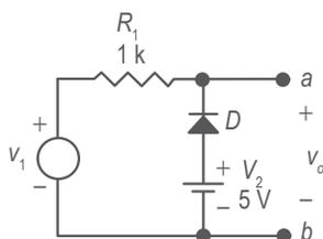
Figura 5. Circuito recortador de voltaje.
