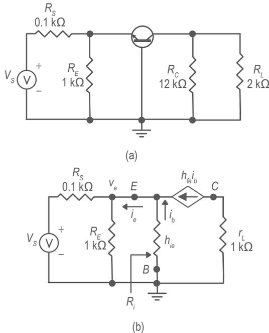
**Figura 3.** (a). Circuito del amplificador en corriente alterna; (b). Circuito equivalente.
