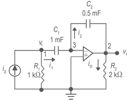
Figura 6. Circuito R-C con los voltajes de nodo y las corrientes del circuito.
