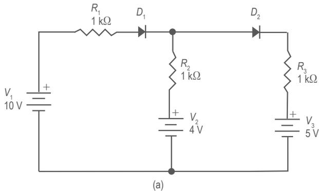
Figura 5. Circuito con diodos.
