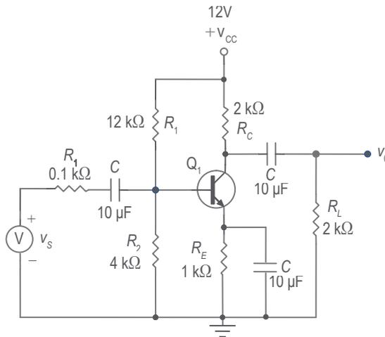
Figura 1. Amplificador en emisor común.
