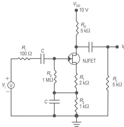
Figura 1. Circuito amplificador en fuente común.
