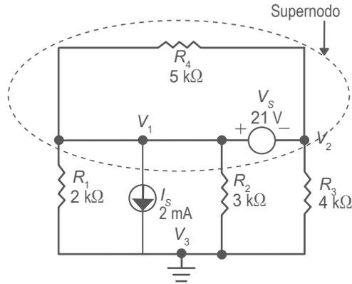
Figura 5. Circuito con el supernodo.
