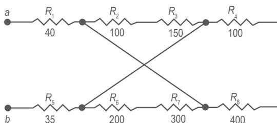
**Figura 1.** Calcular la resistencia equivalente entre los puntos *a* y *b*.
