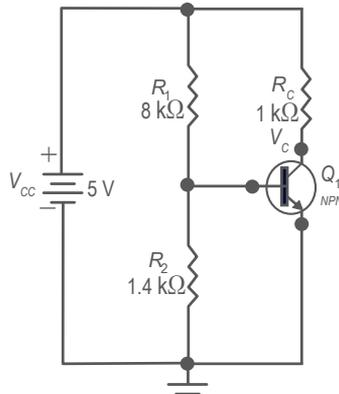
Figura 6. Circuito de polarización de un transistor bipolar NPN.
