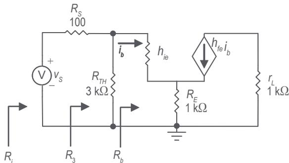
**Figura 5.** Circuito equivalente del amplificador en corriente alterna, con resistencia en el emisor.
