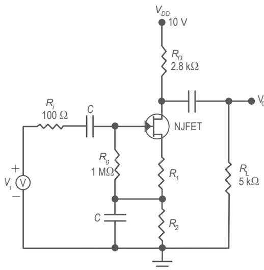
Figura 3. Circuito amplificador en fuente común.
