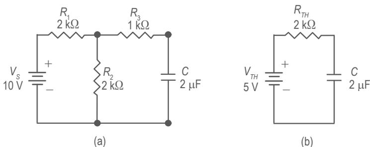
Figura 2. (a). Circuito con un condensador equivalente; (b). Circuito R-C equivalente.
