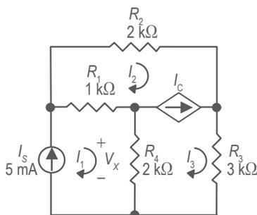
Figura 3. Circuito con una fuente controlada.
