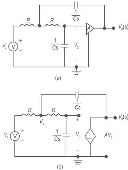
**Figura 4.** Circuito equivalente. (a). Con un amplificador de ganancia  $A$ ; (b). Con el modelo ideal del amplificador de ganancia  $A$ .
