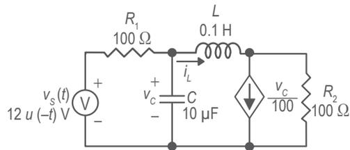
Figura 3. Circuito RLC con una fuente controlada.
