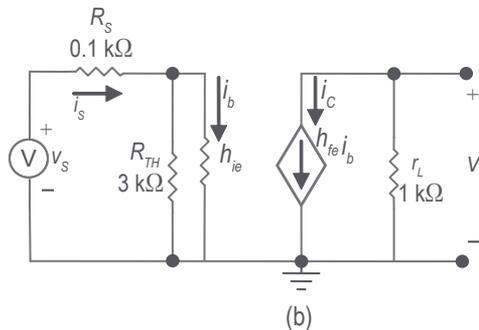
Figura 4. Circuito equivalente del amplificador en corriente alterna.
