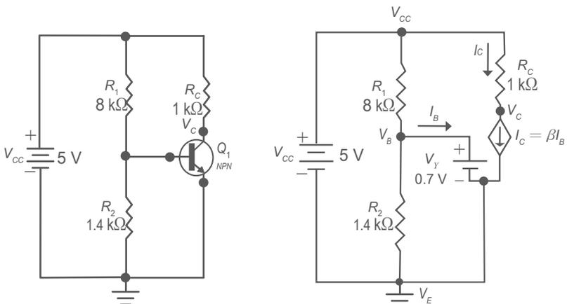
Figura 7. (a). Circuito original; (b). Circuito equivalente.
