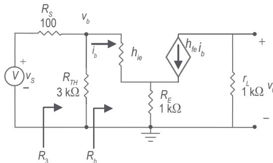
**Figura 6.** Circuito equivalente del amplificador en corriente alterna, con resistencia en el emisor.
