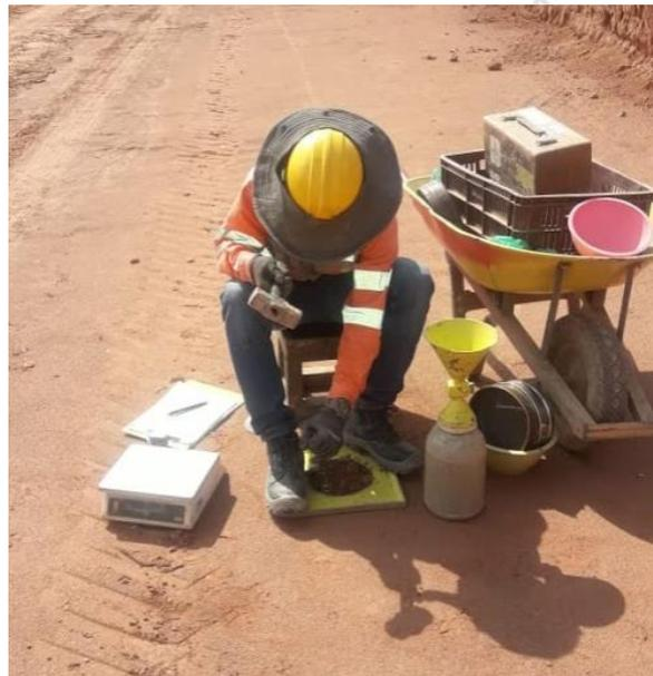
**Imagen 18.** Ensayo del cono de arena en campo. **Fuente:** Elaboración propia.
