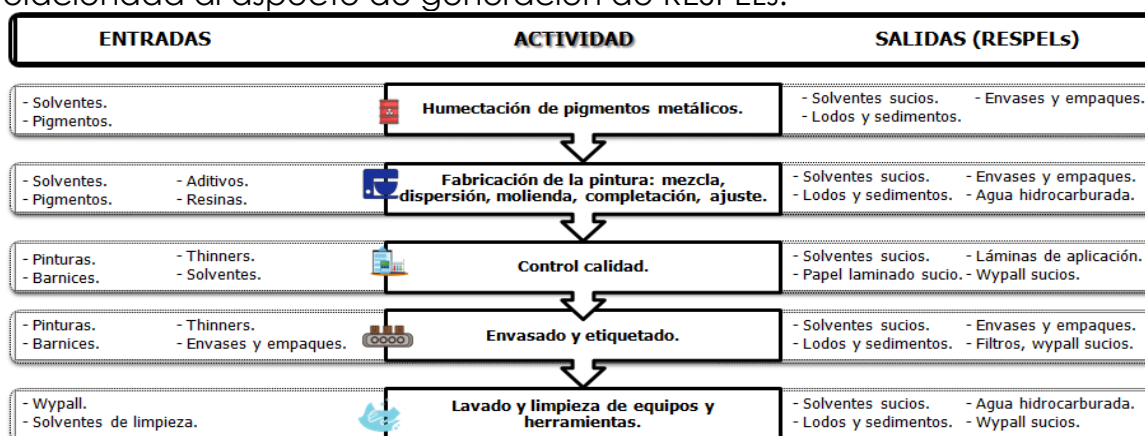
Figura 3. Flujo de materiales en las actividades de la Figura 2 con los impactos negativos más significativos en el proceso de fabricación de pinturas.
