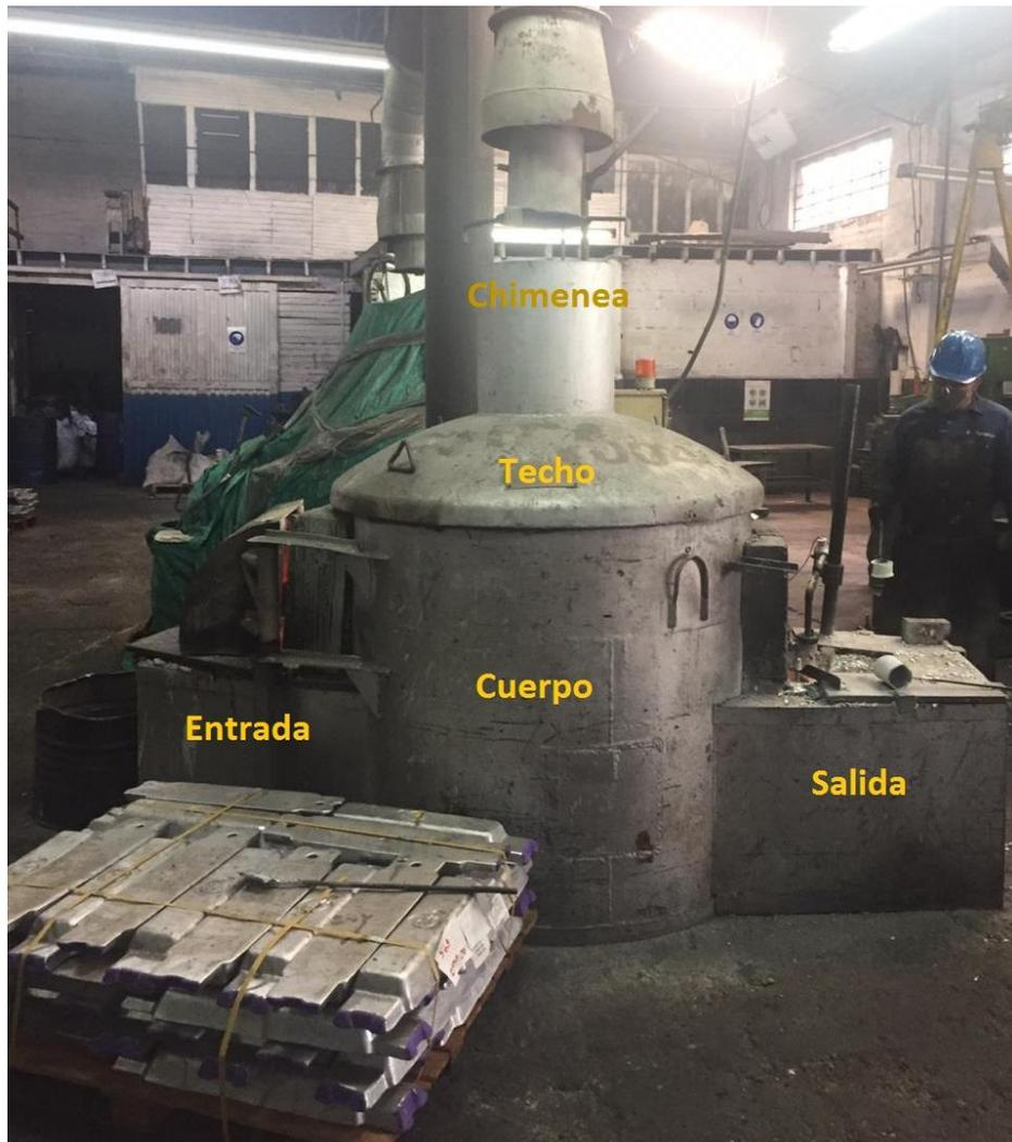
Figura 12 Disposición horno HFN004
