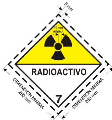
Figura 1. Dimensiones mínimas del rotulo para el transporte de sustancias químicas peligrosas
