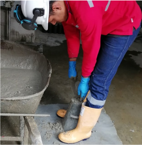
Imagen 3 Llenado del cono de Abrams
