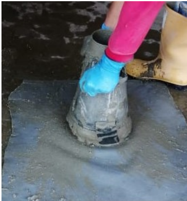
Imagen 7 Levantamiento del cono
