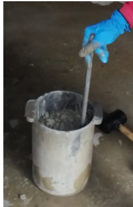
Imagen 18 Compactacion con la varilla
