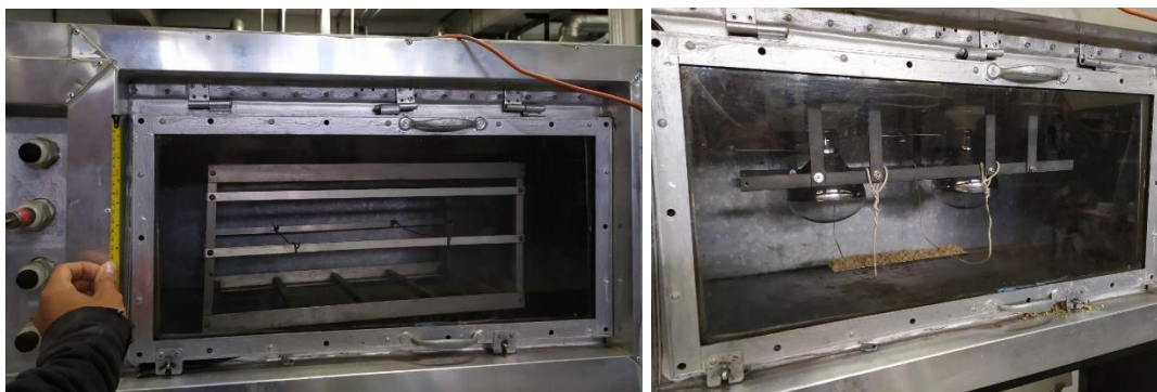
Figura 47. A) Túnel de secado por convección, B) Túnel de secado híbrido
