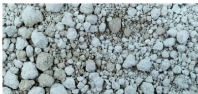
Figura 60. Muestra de arcilla al secarse por radiación pura
