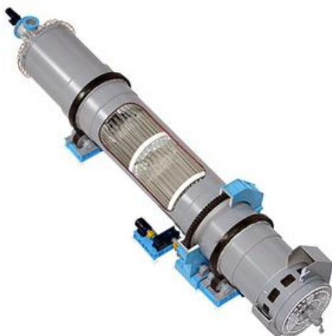
Figura 22. Modelo conceptual del secador de tubos por vapor [57]
