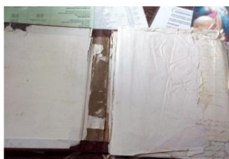
1. Desprendimiento del lomo
