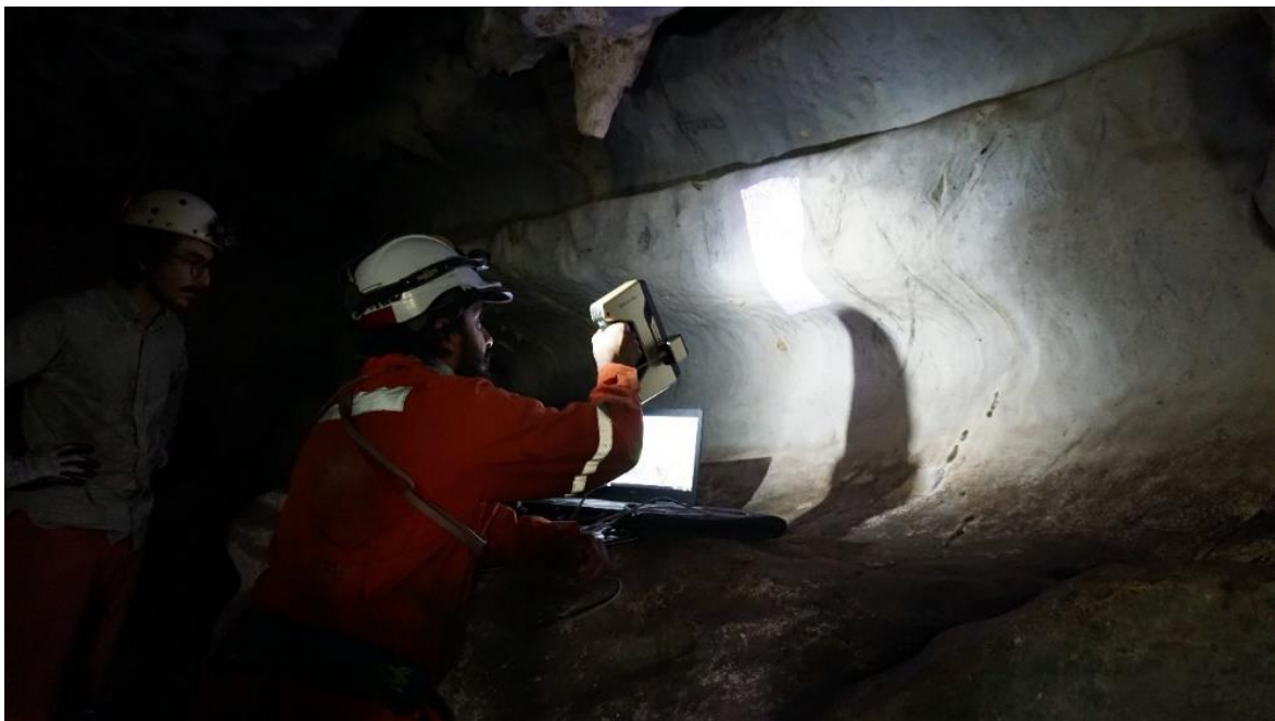
Foto 74. Caverna La Gruta. Documentación de lienzo mediante escaneo con luz estructurada. Foto: FPCP, 2019.
