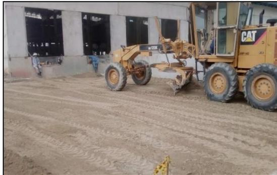
Figura 10. Motoniveladora.
