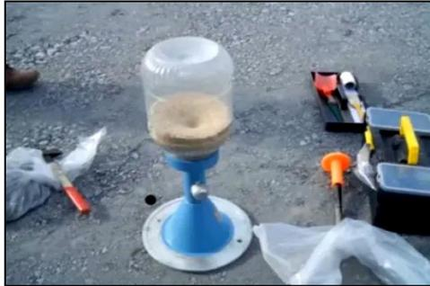
Figura 7. Ensayo de densidad de campo con cono de arena.
