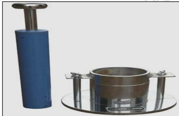
Figura 6. Martillo y molde para Proctor modificado.
