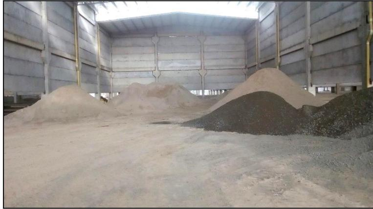
Figura 4. Triturado y arenilla para Subbase granular.
