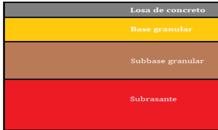
Figura 2. Estructura de pavimento rígido de bodegas.
