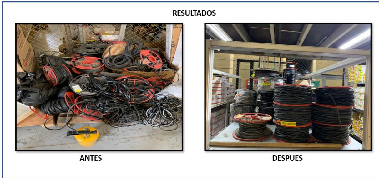
Figura 3. Condiciones del almacén (Antes y después) de aplicada la herramienta 5's. Fuente propia, (2020)
