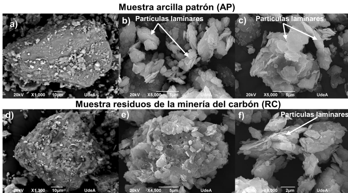
Figura 26. Micrografías MEB de las muestras estudiadas: a), b) y c) Arcilla AP y d), e) y f) Residuos RC.
