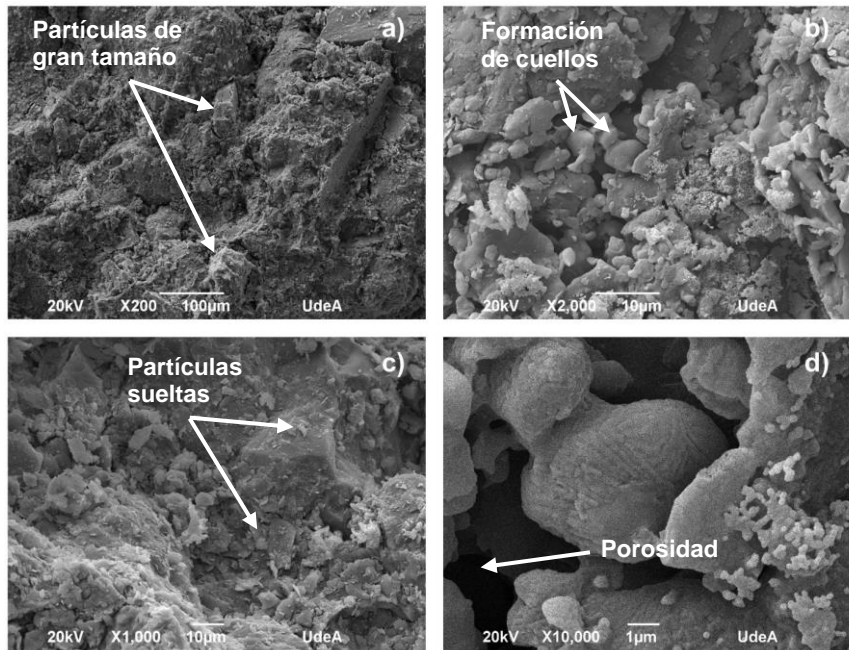
Figura 59. Micrografías de las muestras de AP-RFm 10 % sinterizadas a 1050 °C.
