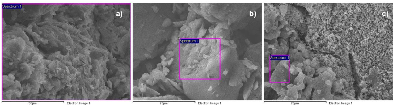
Figura 44. Zonas sometidas a análisis elemental mediante EED para los prototipos AP-RC 60% sinterizados a) 980 °C, b) 1050 °C y c) 1100 °C.
