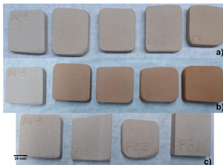
Figura 40. Ejemplo de los prototipos empleados para determinar las propiedades físicas para las mezclas con residuos a) RC, b) RA y c) RF.
