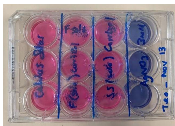
Figura 24 Placa de cultivo perteneciente a las películas control y células sin tratamiento adicionadas con resazurina (2 horas de incubación).
