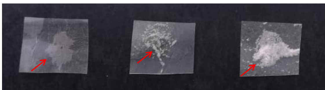
a b c Figura 5 Películas de Fibroína congeladas sin cubrir a. Fibroína 1:1 PVA v/v; b. Fibroína 2:1 PVA v/v; c. Fibroína 3:1 PVA v/v.
