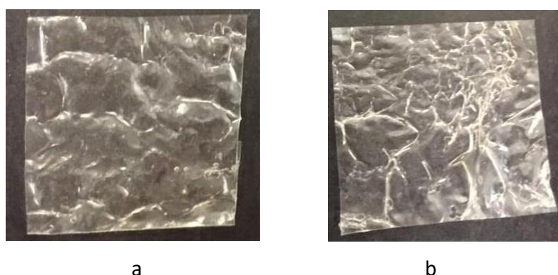
Figura 6 Apósito compuesto de a. fibroína/ sericina + AgNPs 1%; b. fibroína/sericina + AgNPs 2%.
