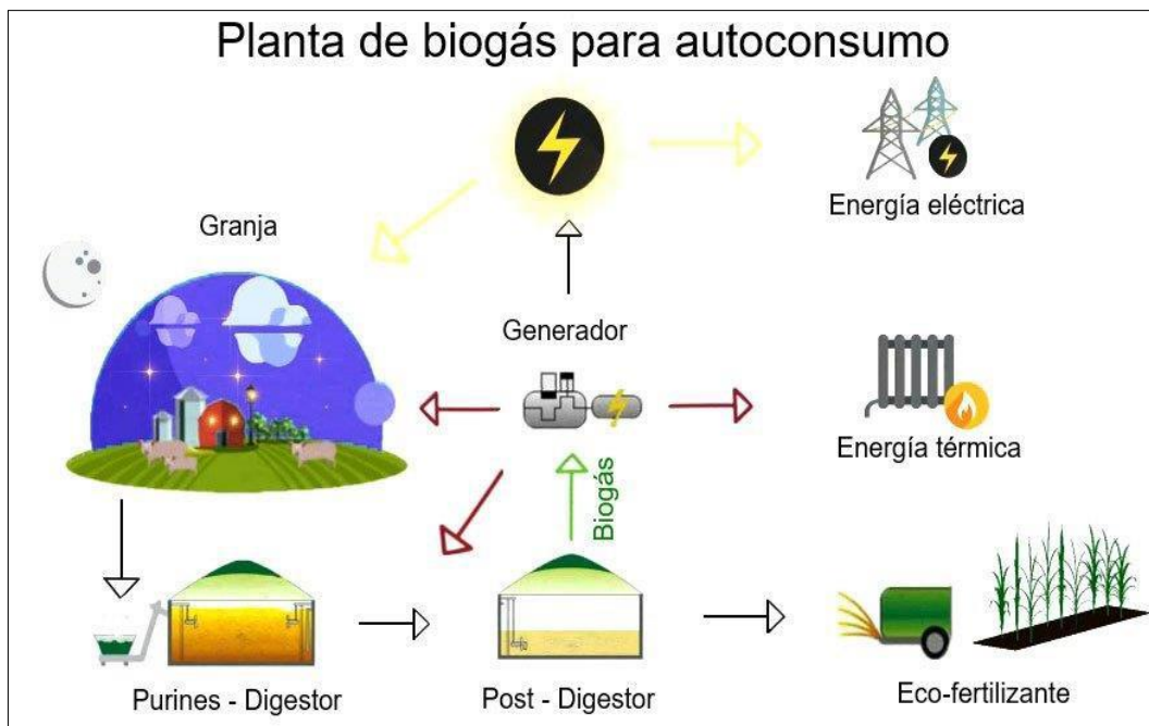
Figura 3. Planta de biogás para autoconsumo.
