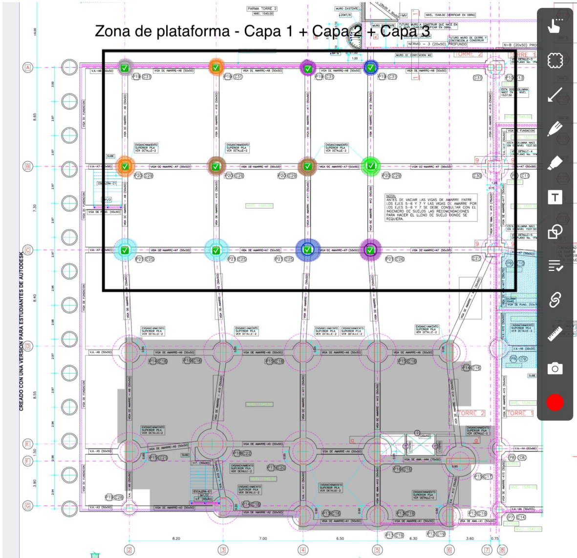
Figura 28: Excavación y vaciado del tercer lote de pilas: Zona plataforma.
