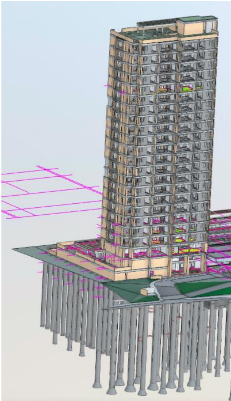
Figura 8: Vista en 3D del sistema de fundaciones.
