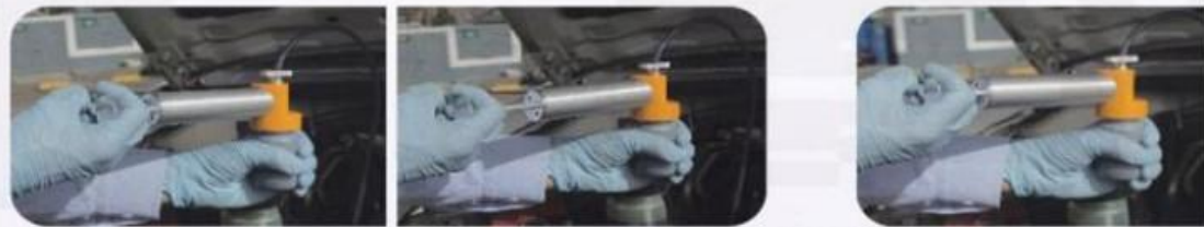
Figura 2: Toma de muestra de aceite. Tomado de: instructivo de toma de muestras de aceites usados PETROBRAS.
