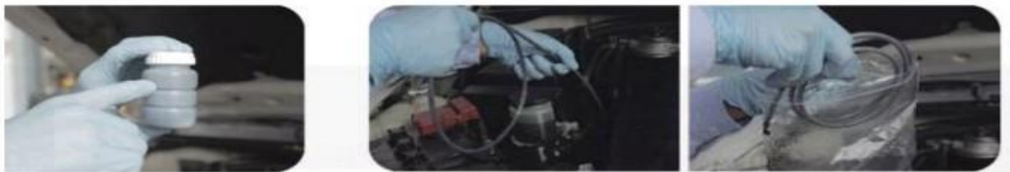
Figura 3: Sellamiento de la muestra. Tomado de: instructivo de toma de muestras de aceites usados PETROBRAS
