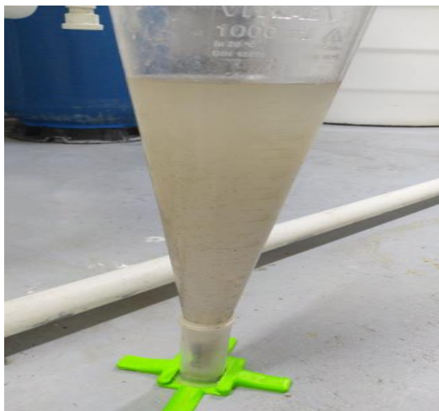
Imagen 5. Medición del volumen de lodos con cono inmhoff
