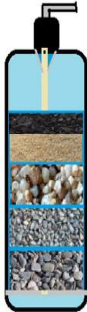
Figura 7. Esquema filtro polyglass. Elaboración propia
