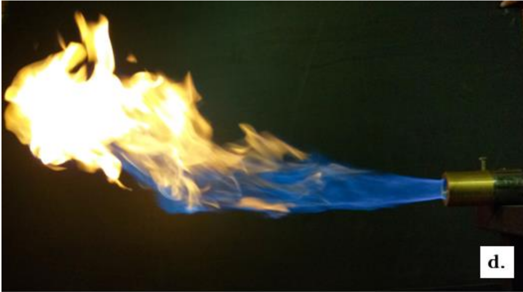
Figura 16 Fotografías de las llamas a.)1.4mm 0.6bar b.)1.4mm 0.8bar c.)2mm 0.6bar d.)2mm 0.8bar
