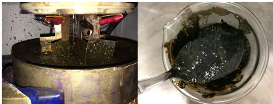
Figura 41. Espuma generada en el proceso de electrocoagulación – Aguas hospitalarias
