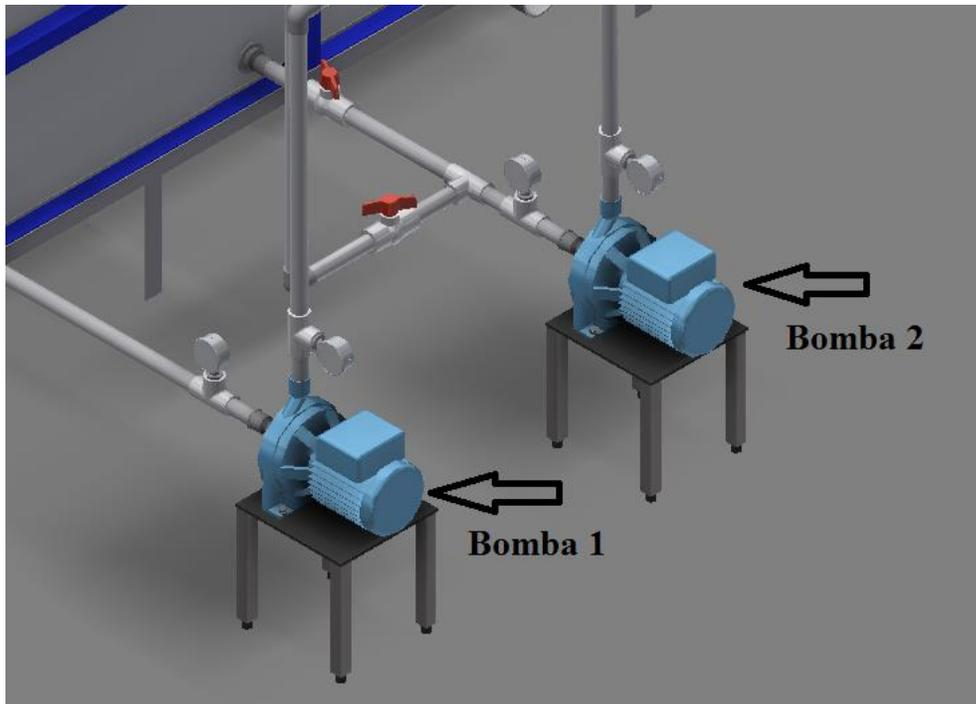
Encender únicamente una de las bombas. Garantizar que todo el caudal pase ÚNICAMENTE por la bomba encendida. Durante el experimento la velocidad de rotación de la bomba DEBE SER CONSTANTE. Seleccionar un valor cercano a 3450 rpm. El primer caudal debe ser cero.
