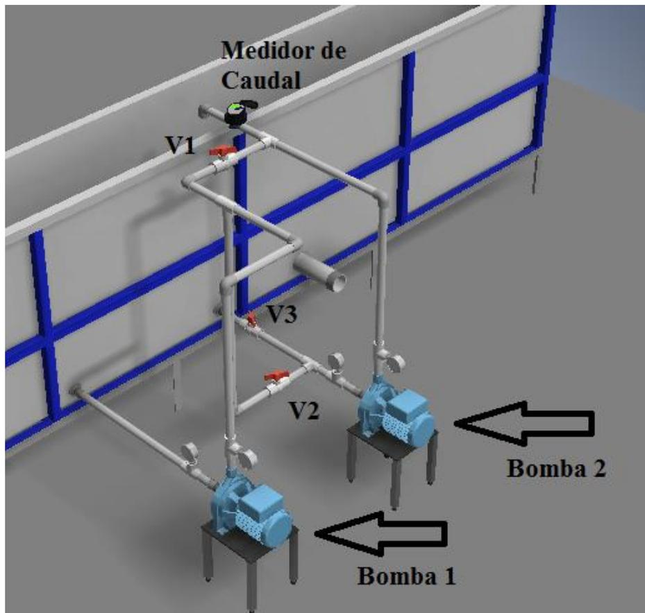
Encender la bomba 1, cerrar las válvulas 1 y 3, y mantener la válvula 2 abierta. Verifique que se encuentren operando en serie. (La descarga de la bomba 1 debe ser la succión de la bomba 2). Por último, encienda la bomba 2. Las dos bombas **DEBEN OPERAR A LA MISMA** velocidad de rotación. Seleccione un valor cercano a 3450 rpm.
