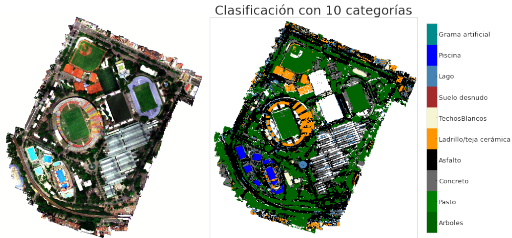
Figura 32. Resultado de la clasificación por umbrales en la Unidad Deportiva Atanasio Girardot. Izquierda: imagen RGB de la Unidad Deportiva Atanasio Girardot. Derecha: resultado de la clasificación por umbrales. Fuente: equipo Teledetección con Drones SIATA
