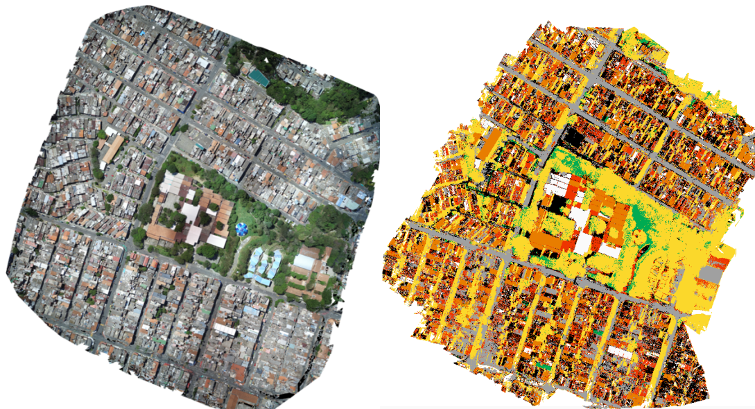
Figura 37. Resultado de la clasificación de IECASD utilizando el método de Random Forest. Izquierda: imagen RGB de la IECASD. Derecha: resultado de la clasificación.
