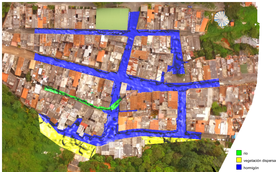
Figura 57. Polígonos trazados de superficies para ingresar al modelo de inundación. Sector La Harenala, Itagüí. Material proporcionado por el equipo de Hidrología de SIATA.
