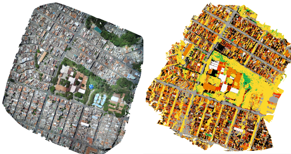
Figura 38. Resultado de la clasificación de IECASD utilizando el método de K-Vecinos más cercanos. Izquierda: imagen RGB de la IECASD. Derecha: resultado de la clasificación.
