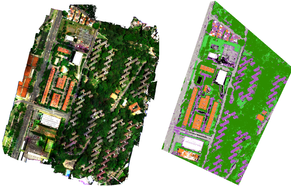
Figura 48. Resultado de la clasificación del barrio Tricentenario con el método de "Random Forest" o Bosques aleatorios. Izquierda: imagen RGB barrio Tricentenario. Derecha: resultado de la clasificación.
