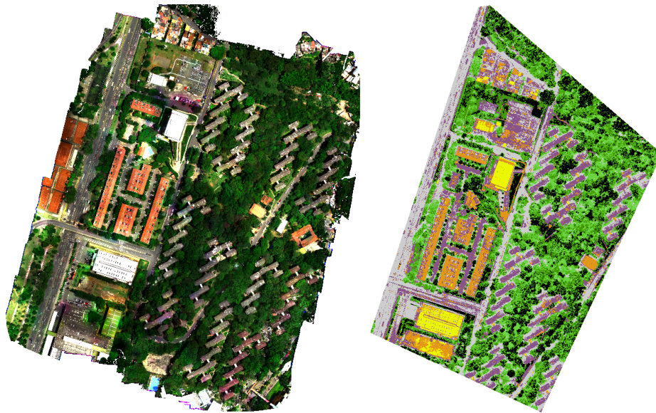
Figura 55. Resultado de la clasificación del barrio Tricentenario con el método k-Means. Izquierda: imagen RGB barrio Tricentenario. Derecha: resultado de la clasificación.
