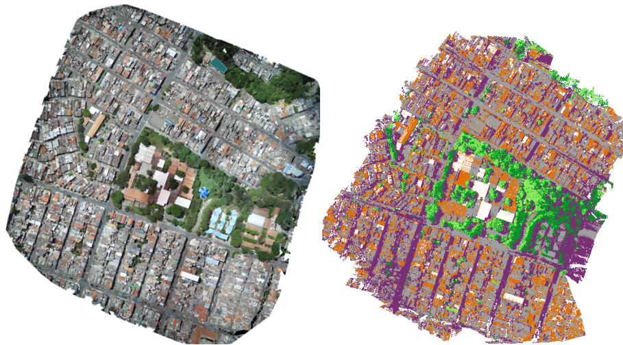
Figura 51. Resultado de la clasificación de la IECASD con el método K-Means. Izquierda: imagen RGB de la IECASD. Derecha: resultado de la clasificación.
