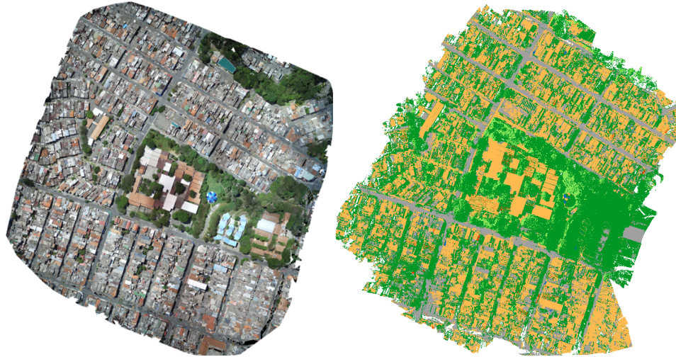
Figura 50. Resultado de la clasificación de la IECASD con el método ISODATA. Izquierda: imagen RGB de la IECASD. Derecha: resultado de la clasificación.
